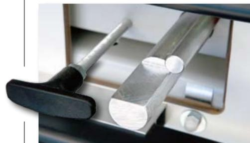
Les barres intermédiaires robustes ont, comme la partie inférieure, une butée de retenue du panneaux, qui évite ainsi que les panneaux ne glissent pendant la coupe horizontale.
