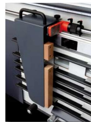
Une butée pivotante et robuste (avec un ajustement micrométrique) sur un axe de guidage en acier 30 mm. Elle peut être équipée en option avec une extension de butée pour la coupe verticale sur les rouleaux. De cette façon il n'est plus nécessaire de lever les panneaux lourds, pour les poser sur la barre intermédiaire, ni de se mettre à genoux devant la machine pour le réglage d'une butée auxiliaire juste au dessus des rouleaux.
