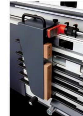
La butée pivotante robuste (avec un ajustement micrométrique) est montée sur un axe de guidage en acier de 30 mm. Elle peut être équipée en option avec une extension de butée pour la coupe verticale sur les rouleaux. De cette façon il n'est plus nécessaire de lever des panneaux lourds pour les poser sur la barre intermédiaire, ni de se mettre à genoux devant la machine pour le réglage d'une butée auxiliaire juste au dessus des rouleaux.
